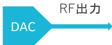
DAコンバータで直接RF信号を出力
