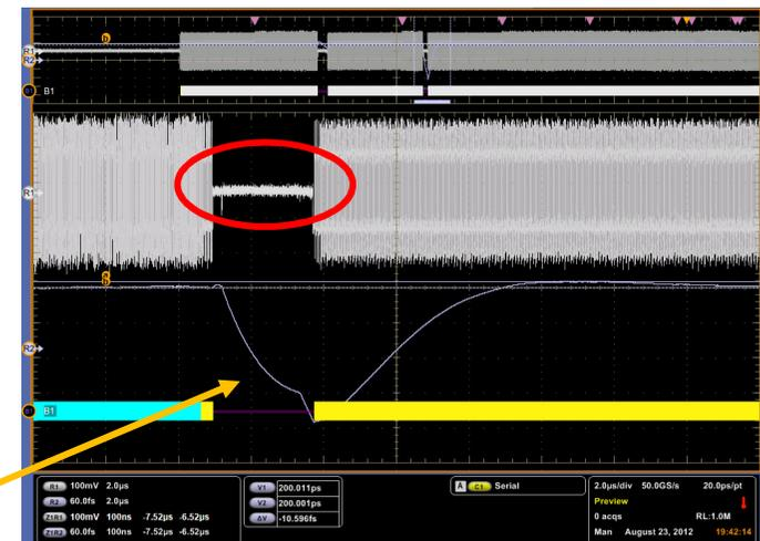
DPOJETで測定したデータ・レート変動
