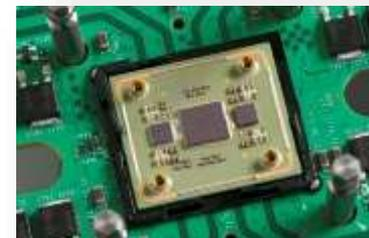
IBM社SiGe 8HP BiCMOSプロセスによる新設計のフロントエンドにより、33GHzで必要とされる垂直ノイズとジッタ・ノイズ・フロアの低減化を実現
