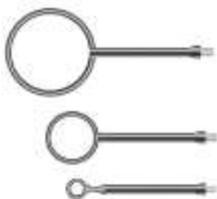
手順3: ハーネスが接続されている制御回路上のノイズを近接界プローブで探索してMDOで周波数観測します。
