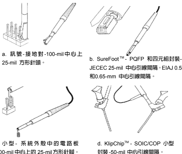
圖 2.15. 小型探棒使用的探棒頭轉接器部分範例。這些轉接器可以明顯容易得多地探測小型電路, 透過提供訊號完整性高的探棒測試單點連接, 可以提高量測準確度。
