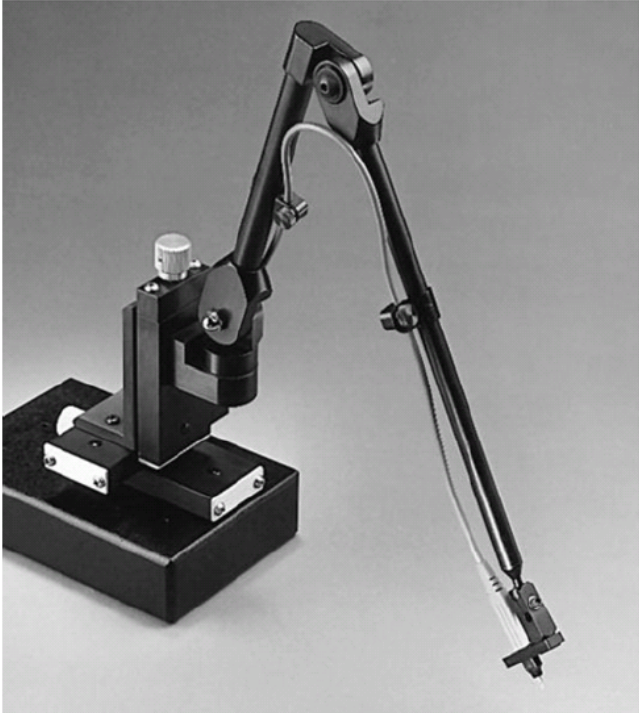
圖2.10. 為探測形狀小的裝置設計的探測站範例，如混合電路和 IC。
