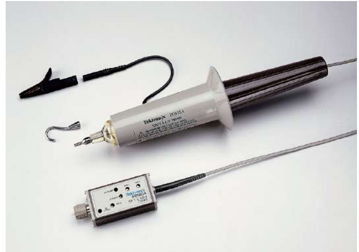
圖2.5. 高電壓探棒提供了 75 MHz 的頻寬，可以量測高達 20 kV 的 DC 電壓及高達 40 kV 的脈衝。
