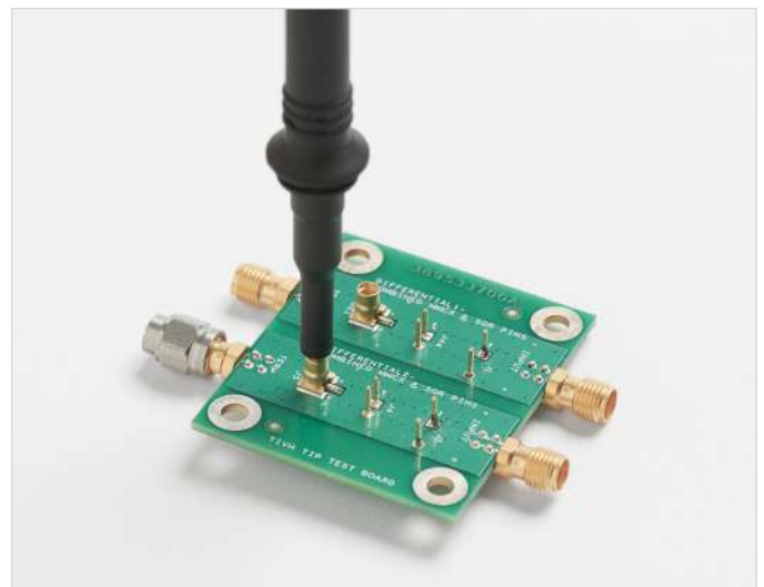
圖 4.3. 安裝了 MMCX 盒的 TPP1000 1 GHz 10X 探棒，直接連接到電路板上的 MMCX 連接器。
