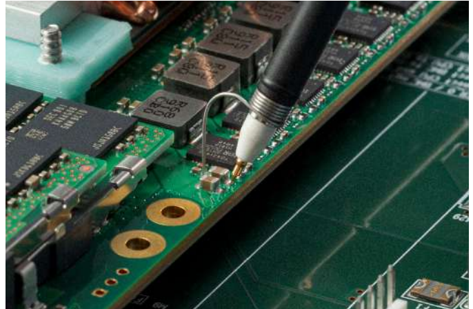
圖 6.8. 接地彈簧可用於透過被動探棒探測低電壓訊號。其提供的接地路徑比接地引線短得多。
