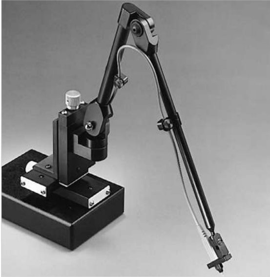
圖 3.14. 為探測形狀小的裝置設計的探測站範例，如混合電路和 IC。
