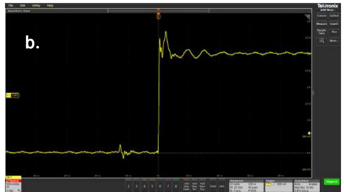
圖 6.3. 由於使用 12.5 吋探棒接地引線 (a) · 快速步驟 (1.5 ns Tr) 會產生偏差。這些偏差可以透過移動探棒電纜或將手放在電纜上來改變 (b)。
