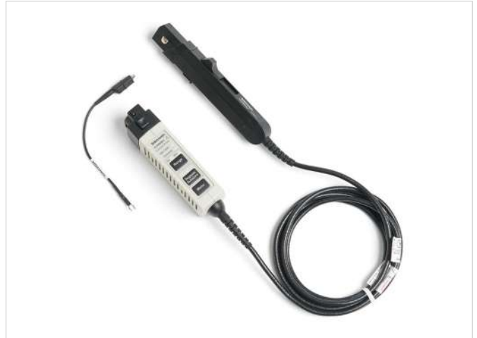
圖 3.12. 分芯 AC 電流探棒範例。在探棒上將導線繞 n 圈可以使有效的靈敏度提高 n 倍。
