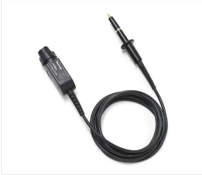
圖 3.6. 高壓探棒可量測高達 20 kV 的直流電壓和高達 40 kV 的脈衝，頻寬為 75 MHz。
