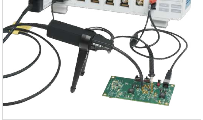
圖 3.7. IsoVu 光隔離探棒具有高頻寬和極高的共模抑制。
