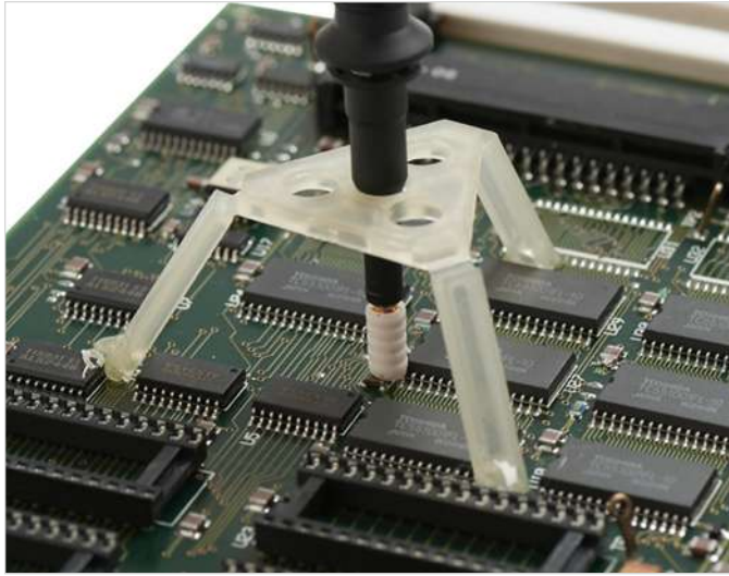
圖 2.1. 大多數探棒由探棒頭部、探棒纜線和補償盒或其他訊號調節網路組成。
