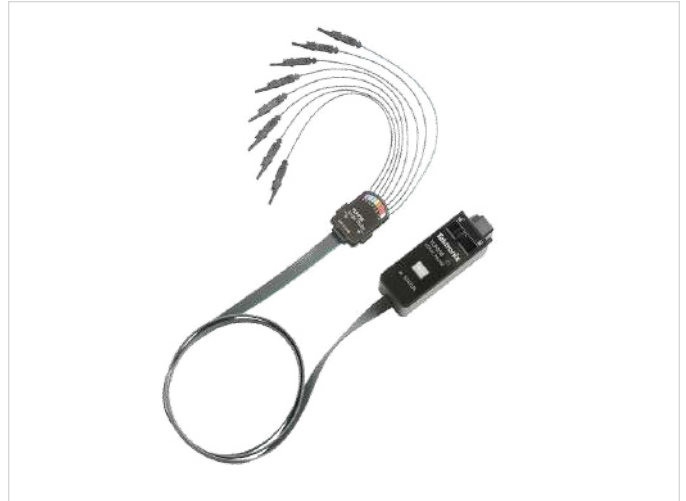
圖 3.13. 適用於混合訊號示波器 (MSO) 的邏輯探棒，簡化到您裝置的連接性。
