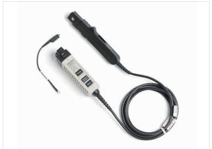
図3.12. スプリット・コア型のAC/DC電流プローブの例。開口部分には分割された変圧器とホール素子、DC電流測定用の制御回路が組み込まれている。
