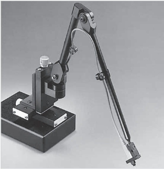
図3.14. ハイブリッド回路やICのような小型形状デバイスをプロービングするためのプロービング・ステーションの例
