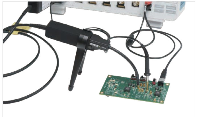
図3.7. IsoVu光アイソレーション型プローブでは、より広い周波数帯域、非常に大きなCMRRが実現可能。
