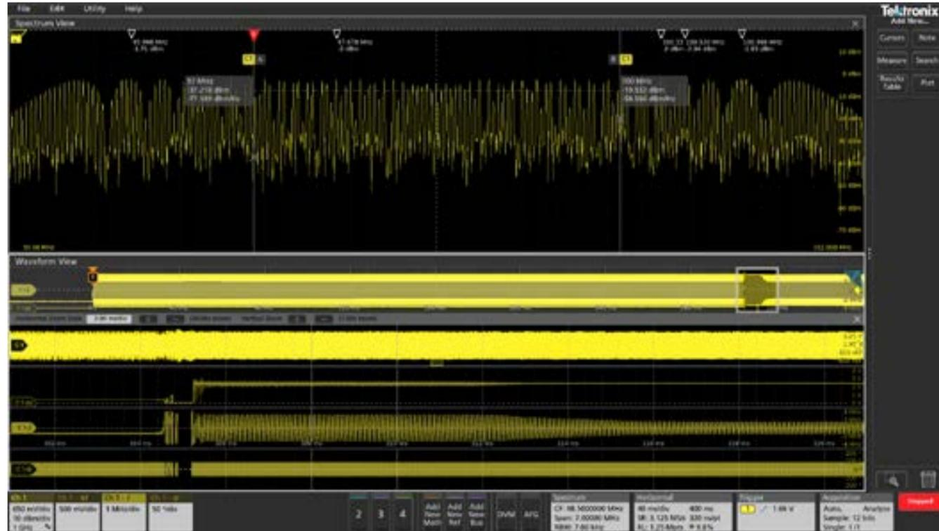
FIGURE 11. En effectuant maintenant un zoom sur la période qui nous intéresse (à environ 300-320 ms après l'événement déclencheur), nous observons clairement que les fluctuations d'amplitude et les variations de fréquences surviennent sur une plage plus large que prévue.
