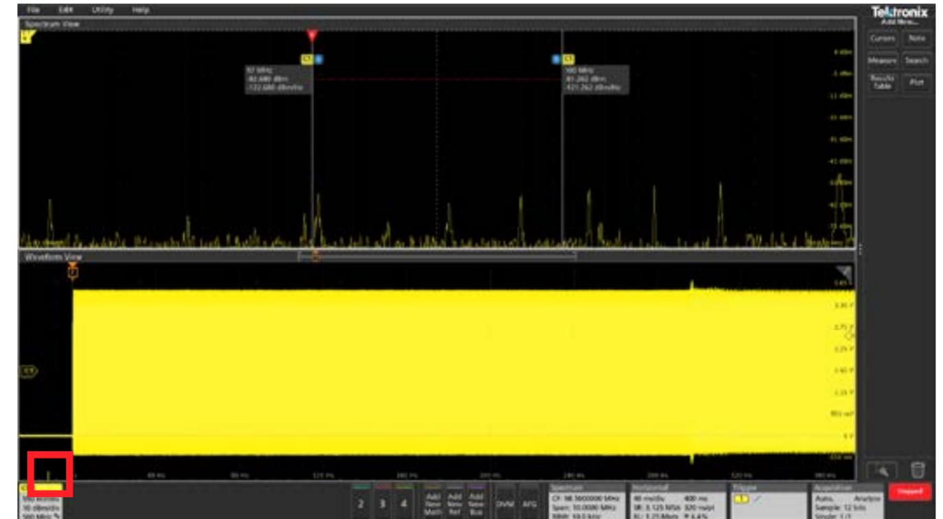
FIGURE 6. L'indicateur de Temps Spectral (carré rouge) est placé au début de l'acquisition, avant l'événement déclencheur. Comme prévu, il n'y a pas de signaux de forte amplitude dans le domaine fréquentiel puisque l'horloge n'a pas encore été mise en marche.
