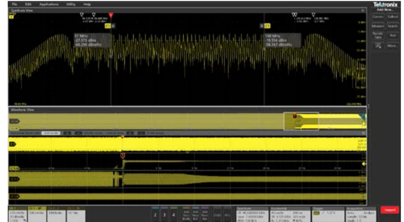
FIGURE 13. Pour nous focaliser sur la phase de mise en marche de l'horloge, nous pouvons déclencher l'acquisition en nous référant à la forme d'onde de l'amplitude RF en spécifiant un seuil et un front en optant pour un mode de déclenchement RF en fonction du temps. (Notez que cette mesure a été effectuée avec un firmware plus récent que les mesures présentées sur les figures 10 à 12).
