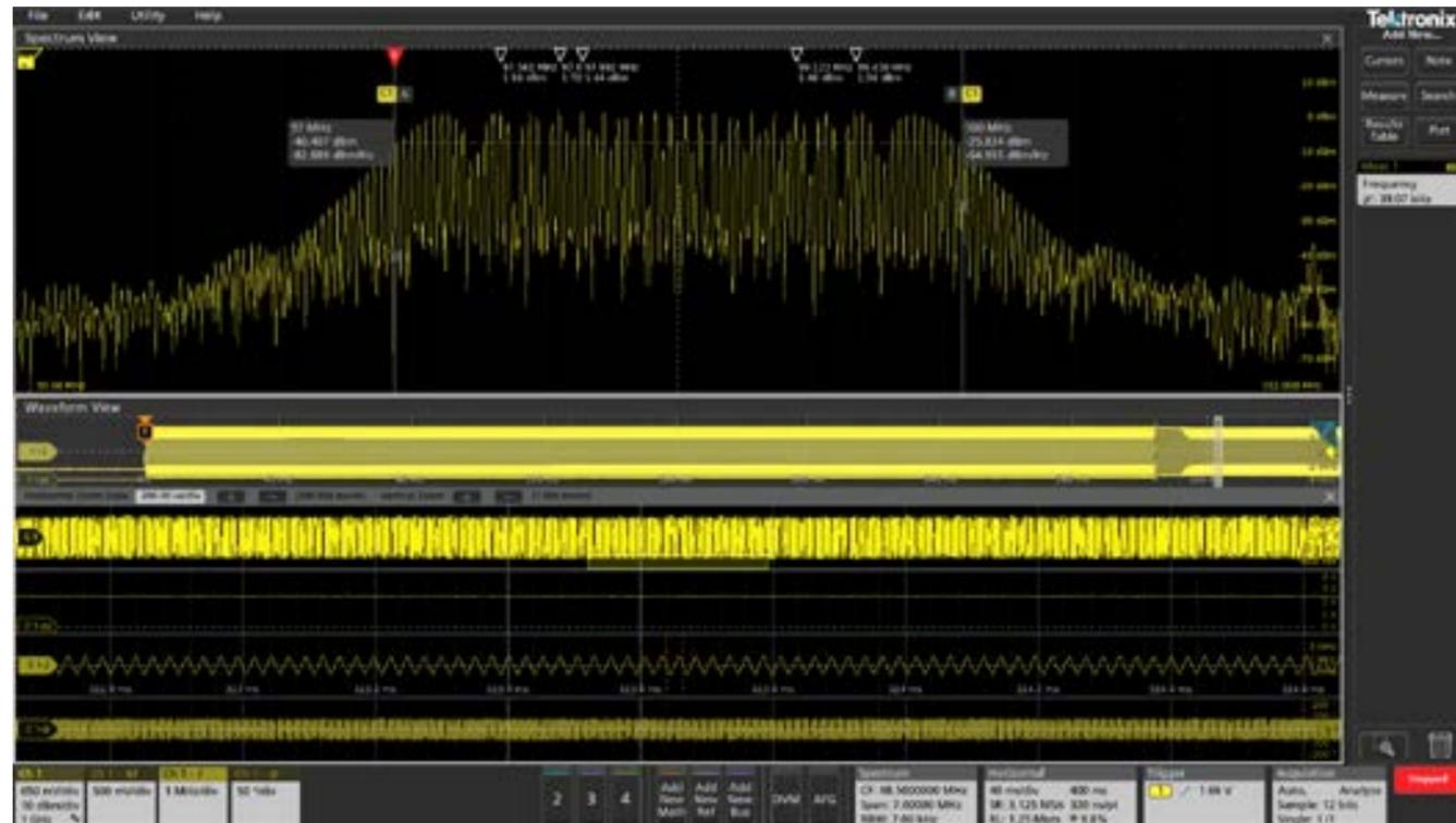
FIGURE 12. En zoomant davantage, nous visualisons clairement la modulation de fréquence triangulaire mise en œuvre. La mesure automatique dont la valeur apparaît dans la barre de résultats confirme que le taux de modulation obtenu de 39,07 kHz est correct.
