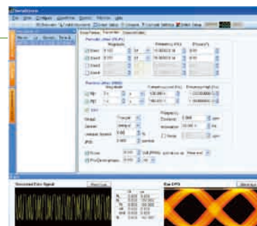
SerialXpressソフトウェアにてSATAのジッタ耐性テスト用の信号が簡単に作成可能
