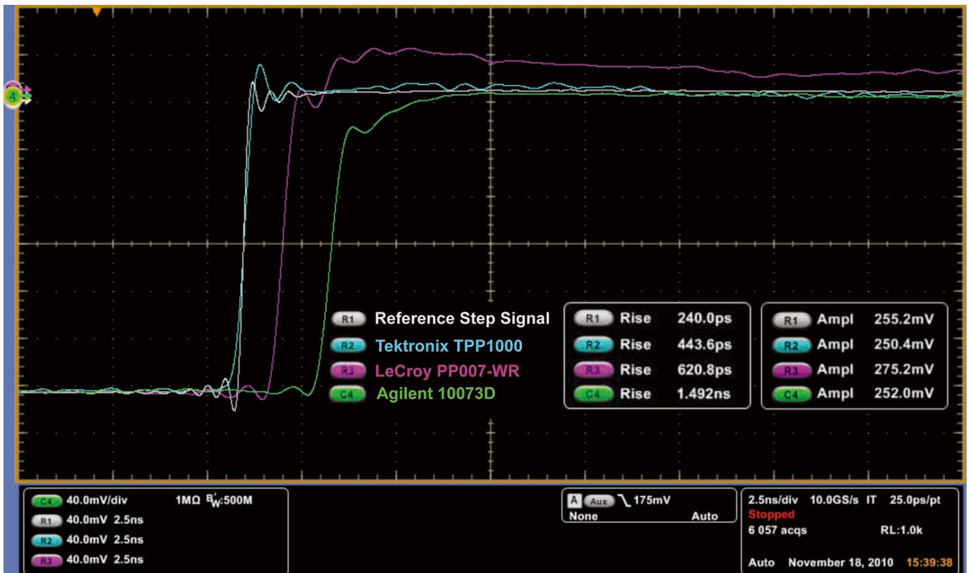
図1. テクトロニクス、レクロイ、アジレントの一般的な受動プローブの立上り時間
