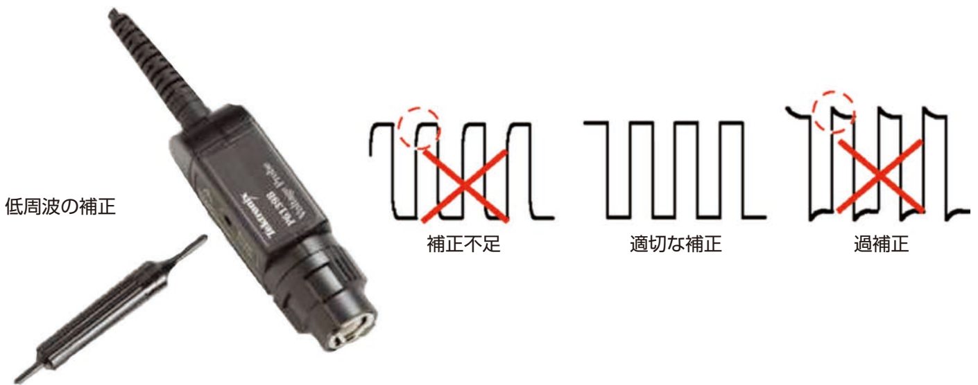
図4. プローブの低周波補正
