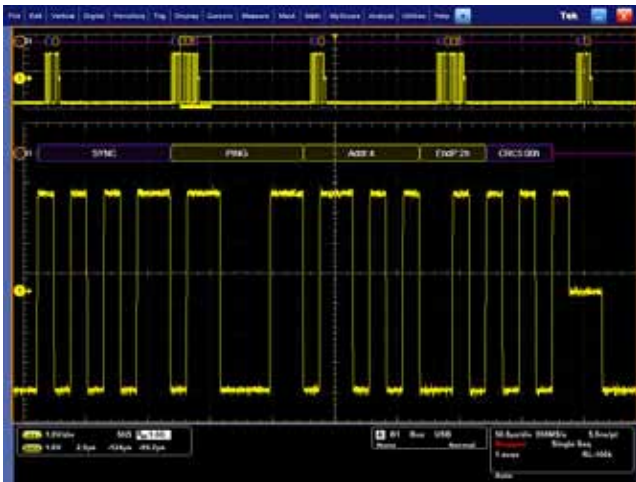
USB 的解码数据颜色显示，显示出了同步、PID、CRC 和停止位的信息。
