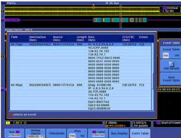
DPO4ENET 方案的 100BASE-TX 包含时间标记的解码事件表
