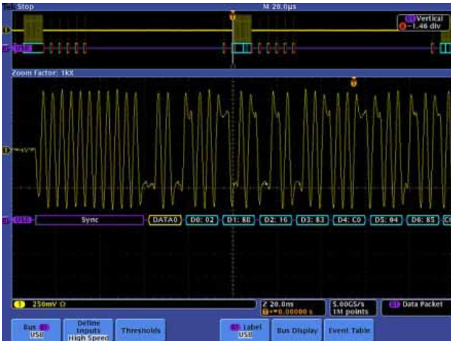
高速 USB 解码显示，自动显示了总线的内容。
