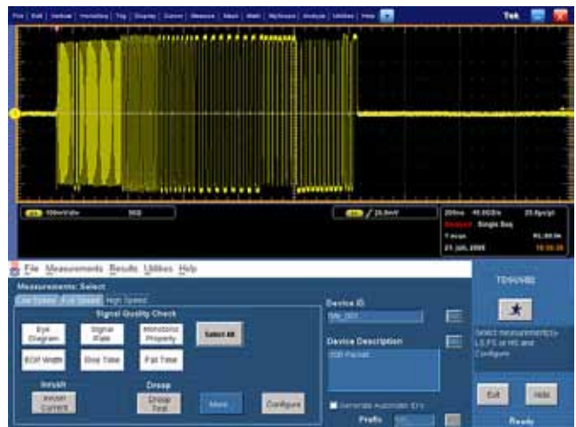
信号完整性的测试设置
