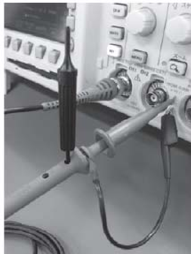
▲写真2 プローブ補正の例
