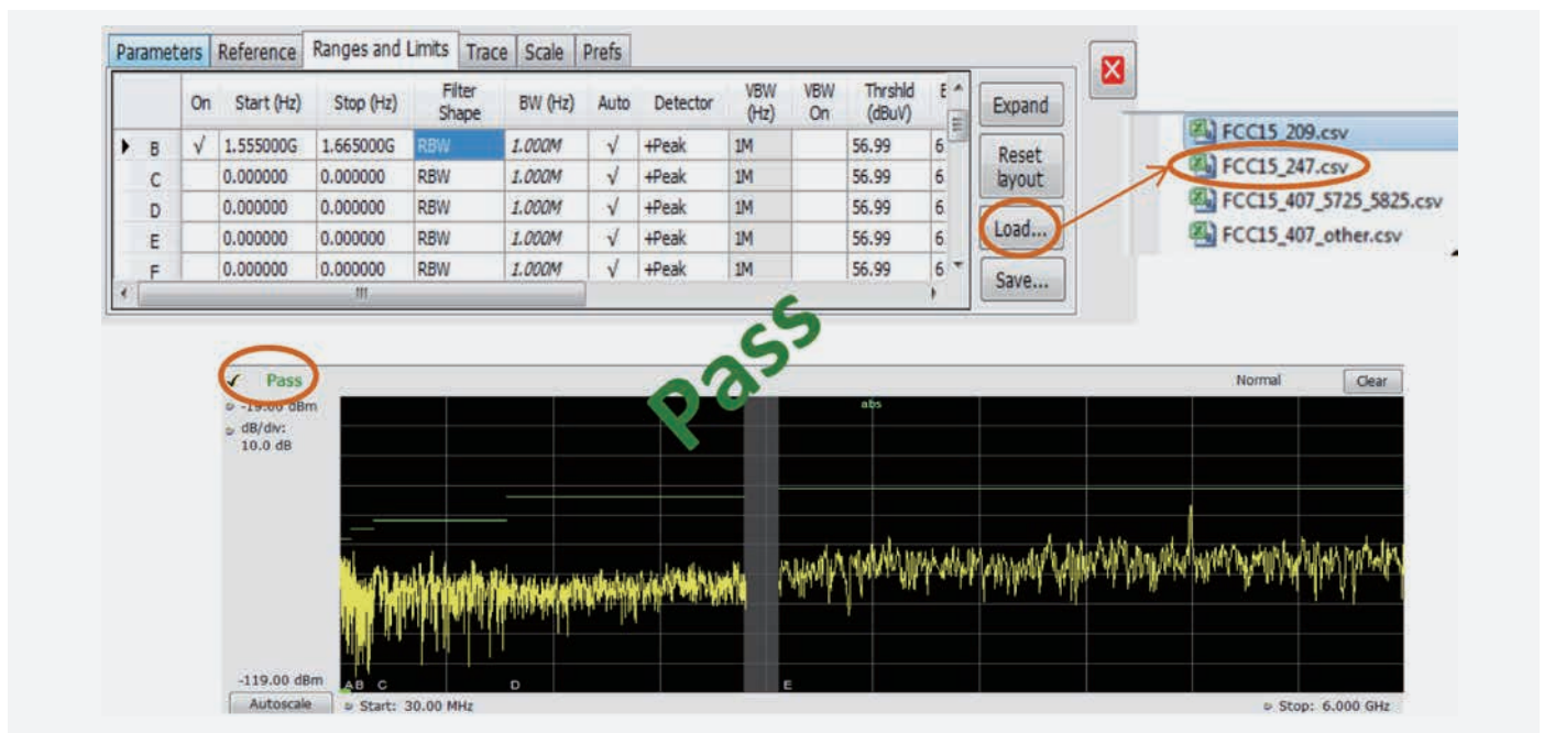
図17. FCC 15.247信号のスプリアス放射テストの例 (大きな偏差)
