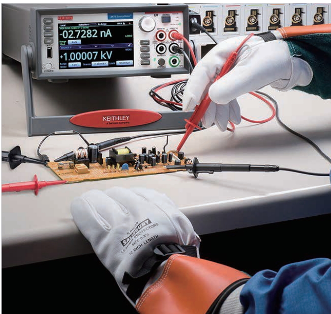
図5. 通電コンポーネントで高電圧を扱うときに適切な安全手袋を使用します。
