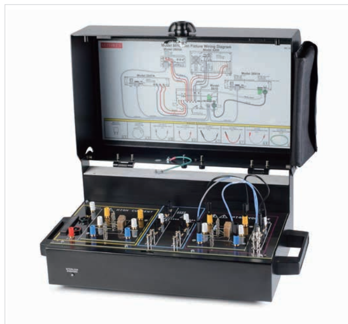
図3. 適切に接地されたテスト・フィクスチャ
