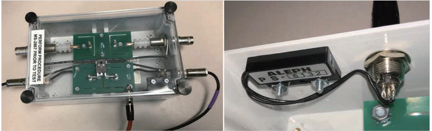
図7. 高電圧ダイオードをテストするための安全インターロック・リレー装置を含むテスト・フィクスチャ
