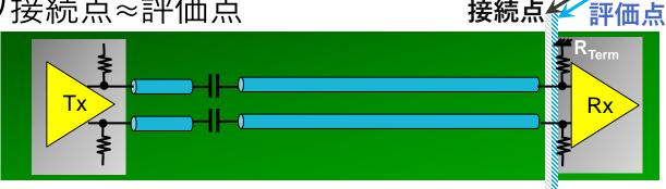
• 今後の基板測定ポイント: プローブ接続点 ≠ 評価点
