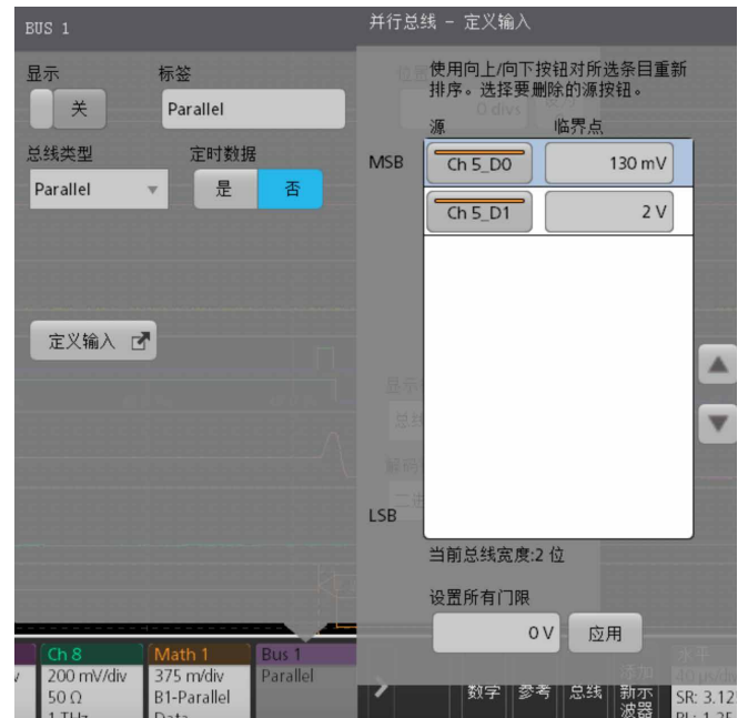
图 6. 实际测试示波器界面示例
