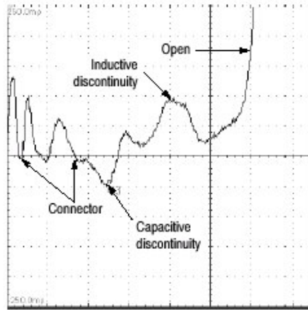
图 13 图 12 中的微带 TDR 波形
