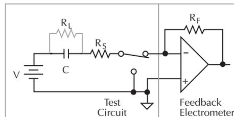
$$\text{Gain: } 1 + \frac{R_F}{1 + R_L j\omega C + R_S}$$
