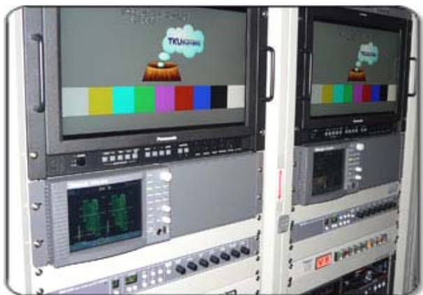
ラックに組み込まれたテクトロニクスの WFM7000 型
