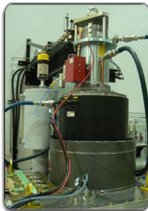
クライストロンの外観。線形加速器にマイクロ波パルスを供給する
