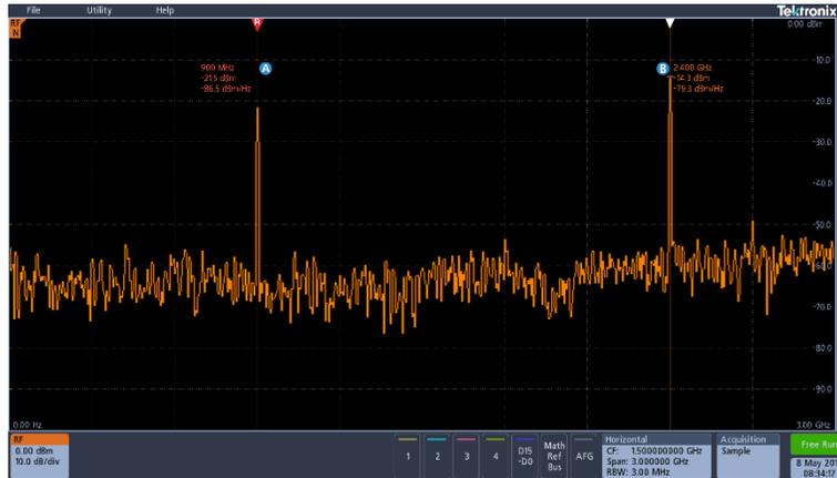
900MHzのZigbeeで受信されたものと、2.4GHzのBluetoothで送信されたパスト状の通信が、1回の取込みで表示された例。
