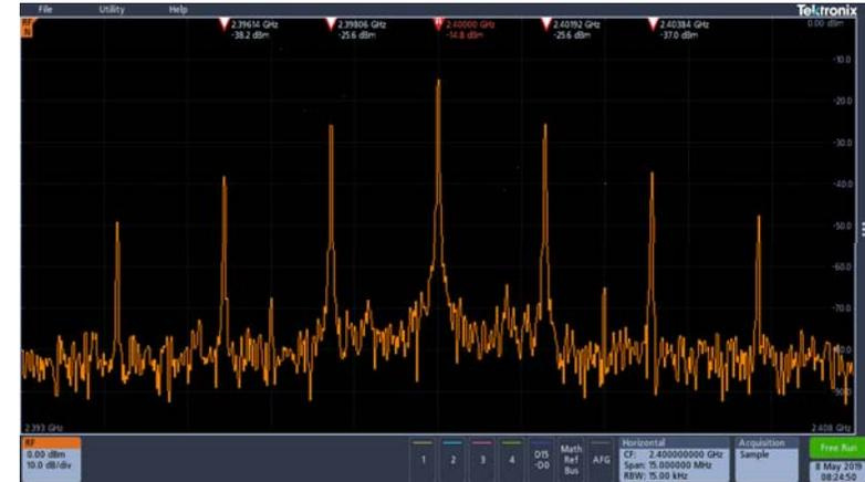
自動ピーク・マーカにより、重要な情報が一目でわかる。この例では、設定したスレッシュホールド／範囲条件に合った5つの振幅ピークに自動的にマーカが付いている。また、ピークにおける周波数と振幅も表示される。
