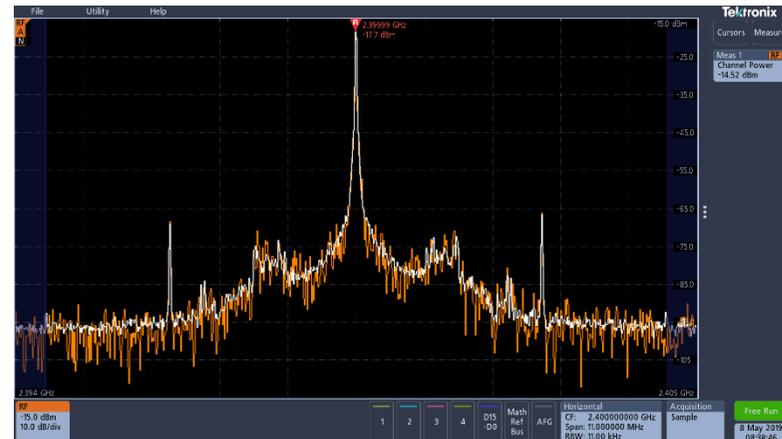
スペクトラム・アナライザの測定項目は、チャンネル電力、隣接チャンネル電力比、占有帯域幅などの一般的なものをサポート。
