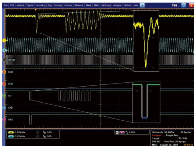
図22. iCaptureによって表示されたチップ・セレクト・ラインのアナログとデジタル表示
