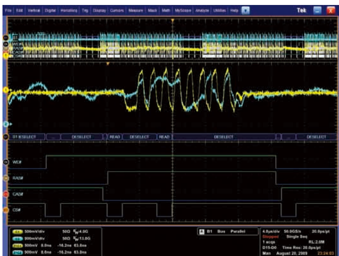
図12. MSO70000シリーズによるDDR3コマンド・バス・デコード例
