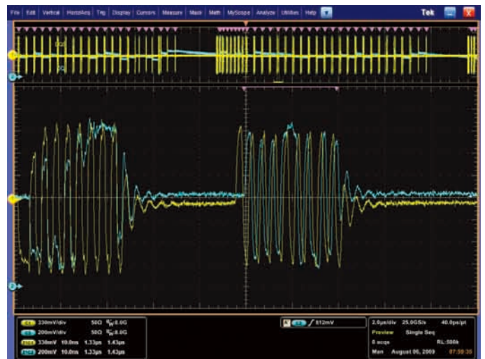
図9. 拡張サーチ／マーク機能によるすべてのライト・バースト信号の自動識別
