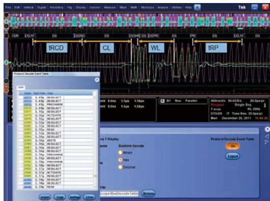
プロトコル・デコード・イベント・テーブルによるコマンド・プロトコル表示 メモリ特性値 (CL-tRCD-tRP) のプロトコル解析が容易に可能です。
