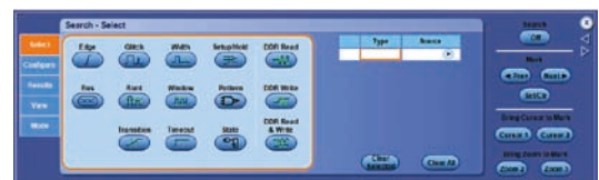
エッジ、グリッジ、ラント、トランジション、パルス幅、ウィンドウ、タイムアウト、セットアップ/ホールド、パターン、ステート、バス、DDR メモリ・サイクル (オプション DDRA) の検索とマーク表示が可能です。
