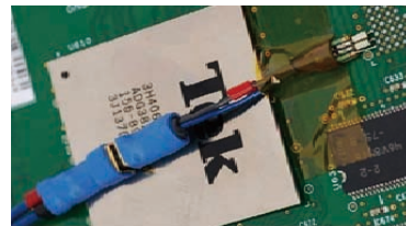
ソケット・ケーブル (020-2954-XX) と TriMode マイクロ同軸チップの半田例
