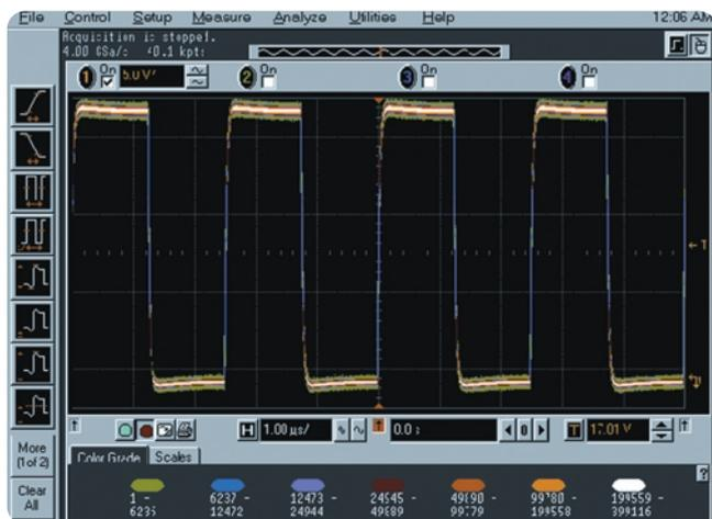
▶ 図1 アジレント社 54855A型における30秒後のスクリーン・ショット。波形取込レートが低いため、間欠的に発生している異常信号が取り込めません。
