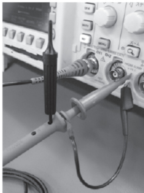
▲写真2 プローブ補正の例
