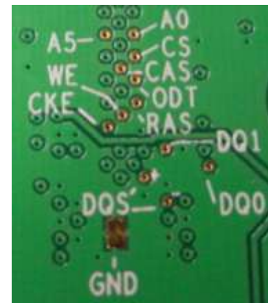
端子直近にビア配置し測定用にレジスト除去
