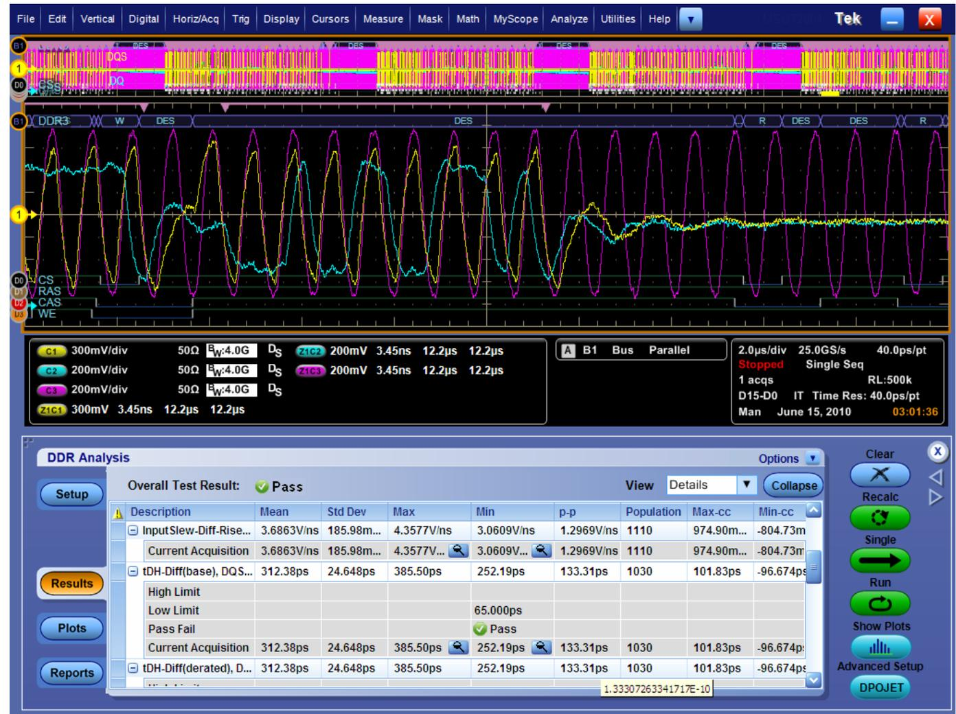
DDR3-1333の自動測定の設定例、tDHのワースト箇所を拡大表示
