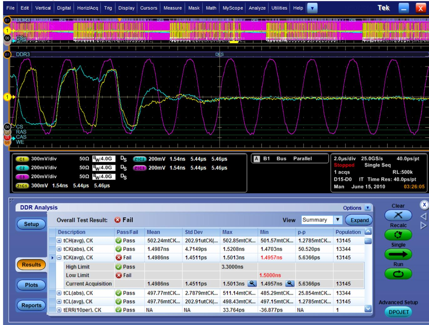
DDR3-1333のクロック自動測定例、Fail箇所を拡大表示
