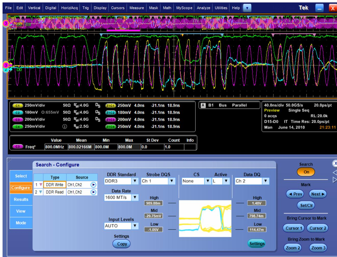
DDRAによるDDR3の読出し、ライト・サイクルの自動識別とマーキングの例
