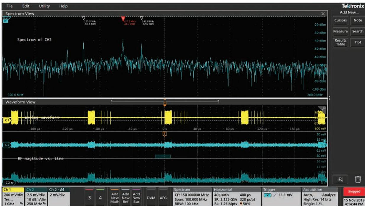
図14. Ch1の受動プローブで信号をプロービングすることで(黄色の波形)、RF(シアン色の波形)に対応した信号が表示される。
