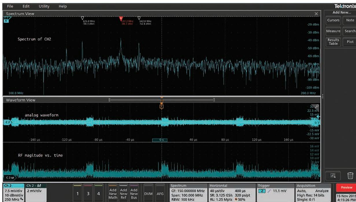
図13. 中央の波形は、磁界プローブの時間ドメイン波形。スペクトラム波形(上)には、波形の下にある青の四角(オレンジで囲まれた部分)で示されるスペクトラム時間に対応する周波数成分が表示される。RF振幅対時間の波形(下)には、繰返しRFパルスが表示されている。
