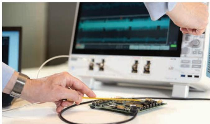
図12. ミックスド・シグナル・オシロスコープのテスト・セットアップにより、アナログ電圧対時間の波形と、独立して調整可能なスペクトラム解析波形の組合せが可能
