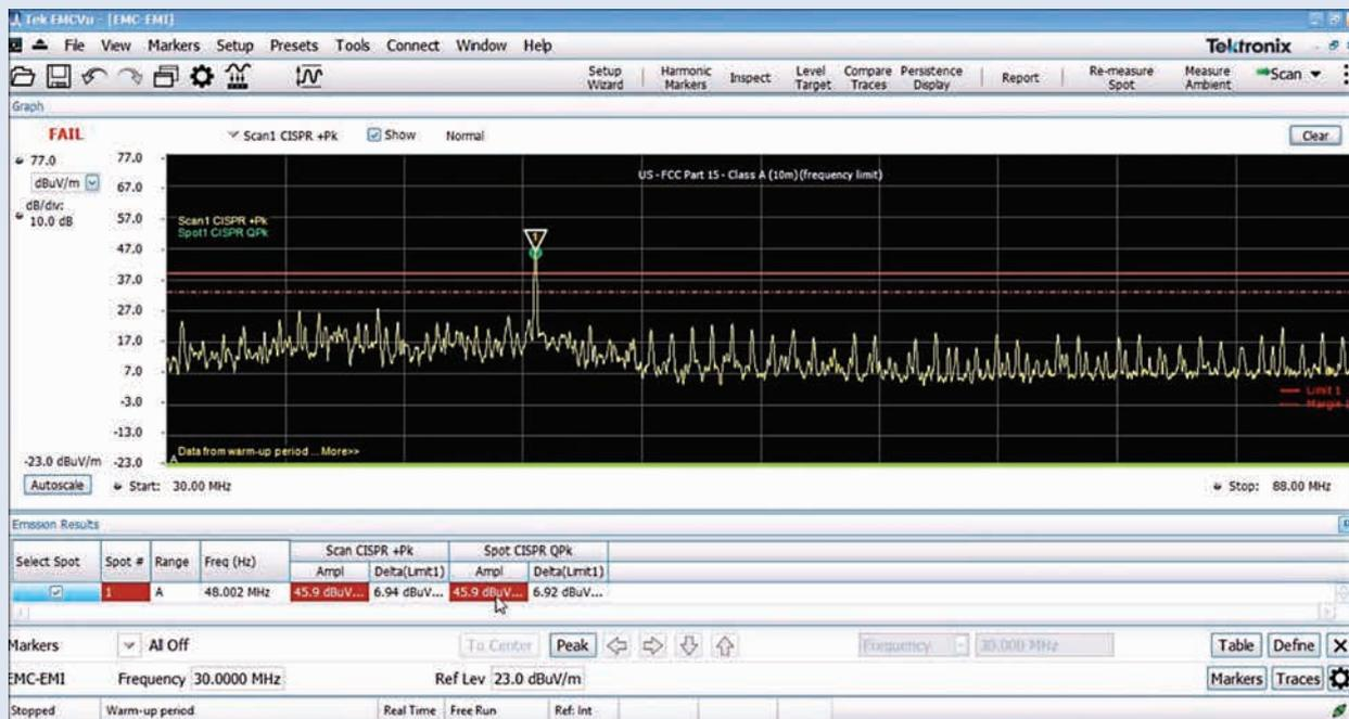
図3. 波形プロットと表による、CW信号のピーク検波とQP検波の比較の例。このプロットは、EMCVuプリコンプライアンス・ソフトウェアとテクトロニクスRSA306B型スペクトラム・アナライザで作成している。
