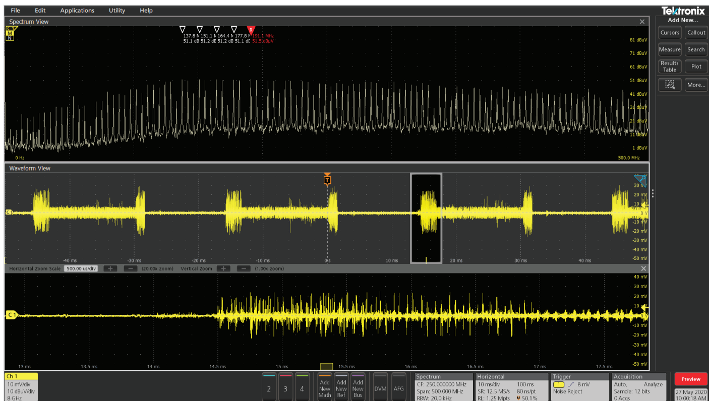
図 9. スペクトラム・タイムを時間領域のノイズの多いデジタル・バーストに移動したところ、EMI が 20dB 増加したスペクトラム・タイムを使用することで、この EMI パルスがケーブルに結合して放射される可能性を解析できます。
