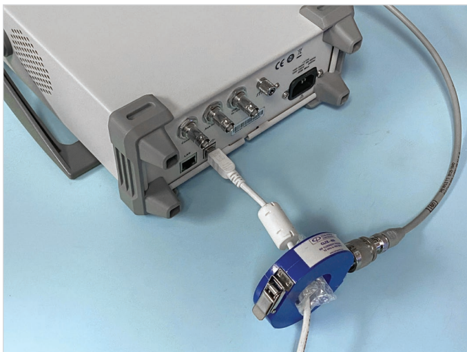
図 3. 電流プローブを使用して、I/O ケーブルや電源ケーブルに流れる高周波電流を測定する
