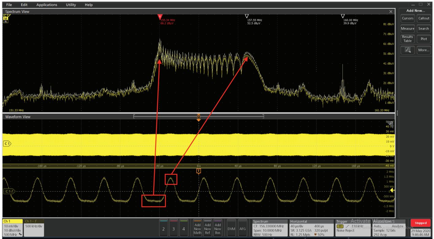
図 21. スプリアス発振の周波数偏差分析では、約 2.2MHz の偏差があり、高い周波数 (157.2MHz) よりも低い周波数 (155.5MHz) の方が、発振が長時間持続していることがわかる
