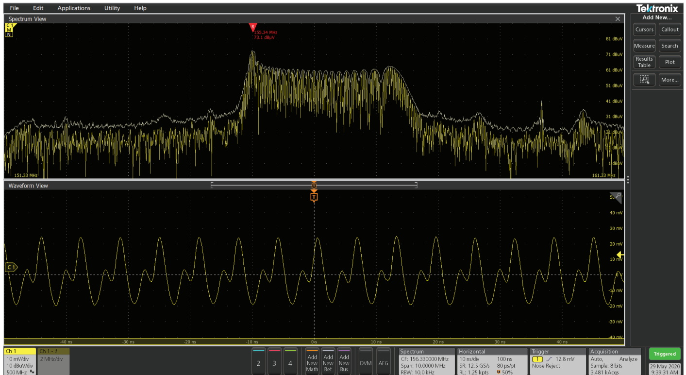
図 18. スプリアス発振を拡大して中央に表示。時間領域の波形をトリガしており、周波数の変化に伴って発振部が伸縮しているのがわかる
