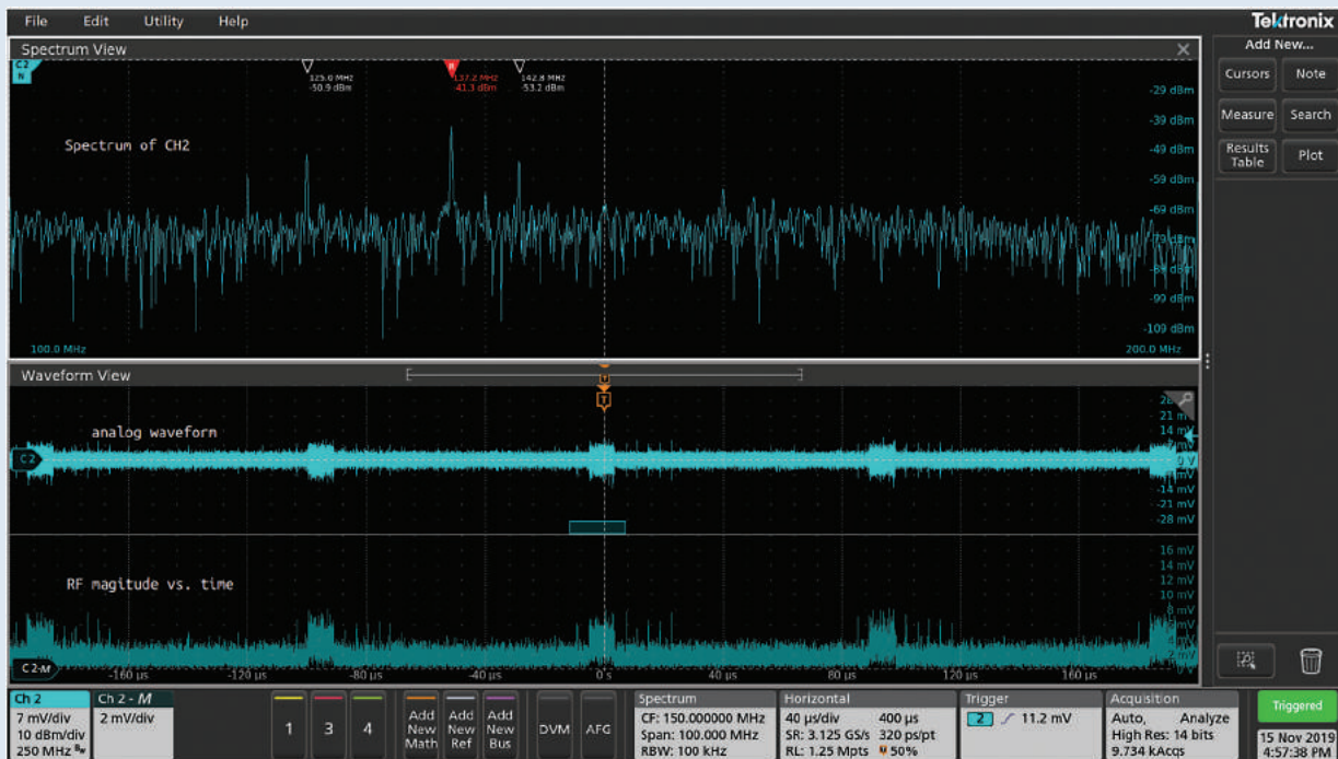
圖10. Spectrum View 可讓您在同一個螢幕上查看時間、頻率和振幅，並且每個域均有唯一可用的量測資料。
