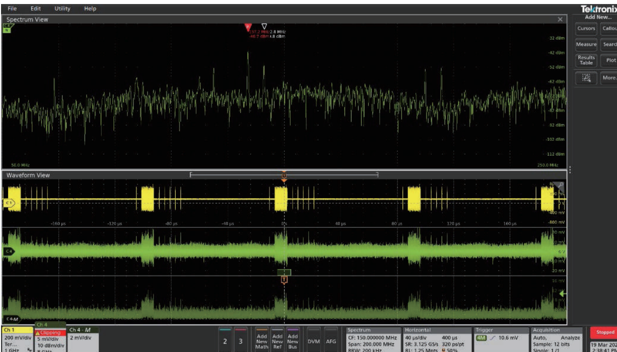
圖 15. 在射頻上觸發 (振幅 vs 時間)，觸發射頻能量並觀察同時發生的電氣事件。
