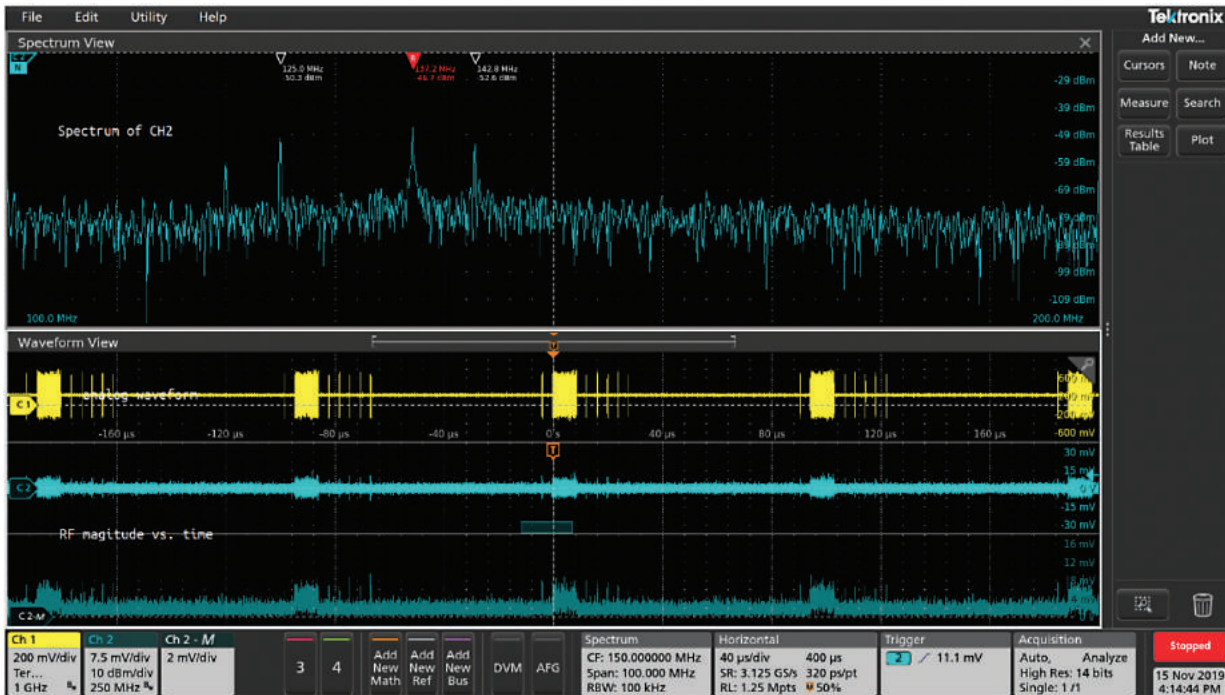
圖 14. 在通道 1 (黃色) 上用被動式探棒探測訊號會發現與射頻 (藍綠色) 相關的訊號。
