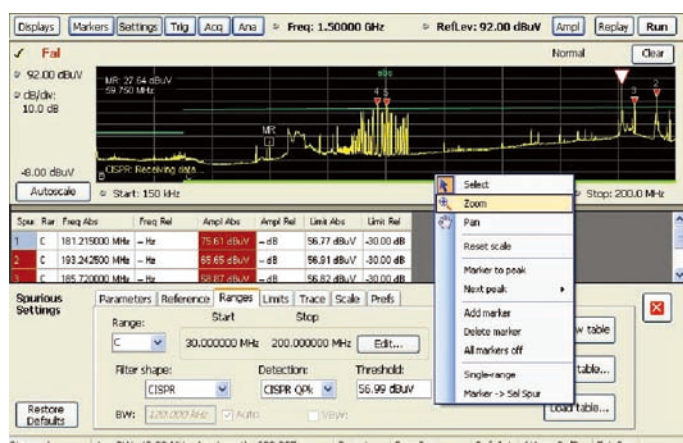
図2. 150kHzから200MHzまでの信号のスクリーン表示。準尖頭値検波器を全スキャンに使用。RSA6100Aシリーズによるスプリアス測定では、各周波数における上限を設定し、アンテナ補正係数を適用することにより、表示信号は傾斜のあるノイズ・フロアになる。ユーザ設定の上限を越えた違反部分は、表の中が赤色で表示される。詳細に観測するには、スクリーン上のメニューで、表示のどの部分でも拡大することが可能
