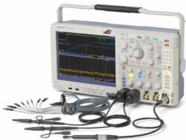
图 1: 泰克 MDO4000 系列把频谱分析仪、示波器和逻辑分析仪组合到一台仪器中，从所有三台仪器中生成时间相关测量。
