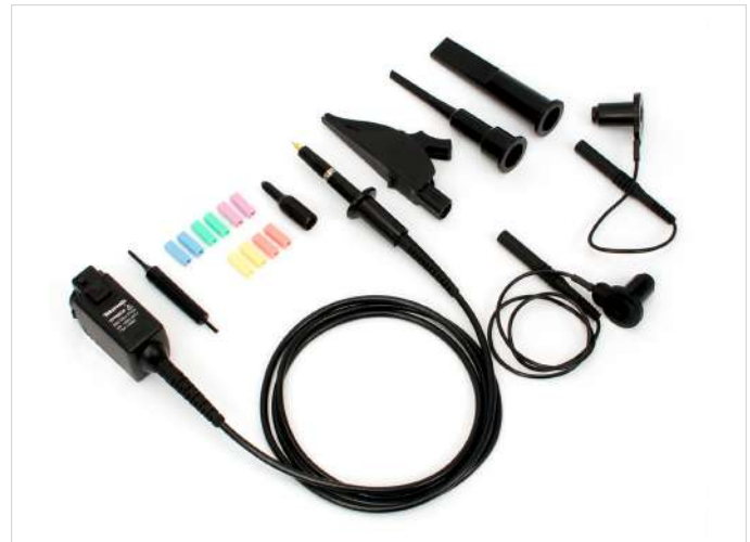
圖 5. Tektronix TPP0850 電壓探棒。具有 50 倍衰減 (最高 100V RMS ) 和 800 MHz 頻寬的單端接地參考探棒。
