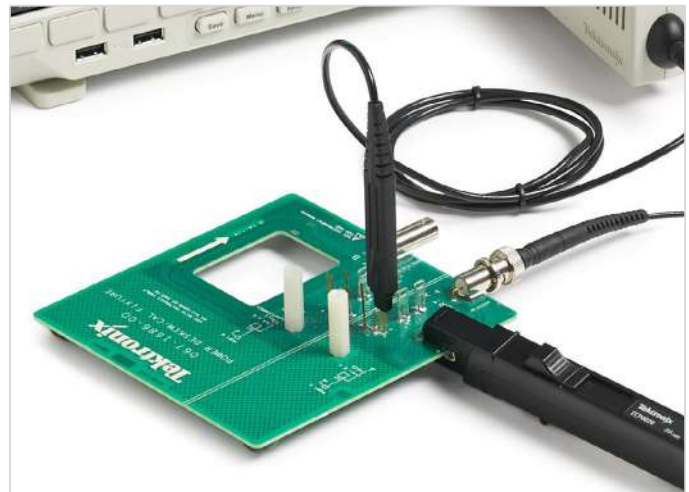
圖 11. 電源量測偏移校正和校準夾具 (067-1686-00)。這些連接為您提供了一種方便的方式來補償電壓和電流探棒之間的時序差異。
