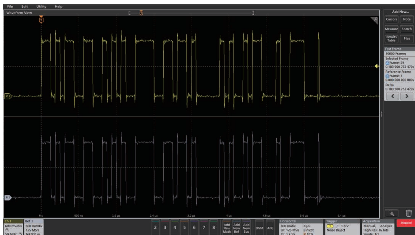
図10. FastFrameは、アクイジションした信号と「ゴールデン」リファレンス波形の詳細比較を視覚的に行っています。
