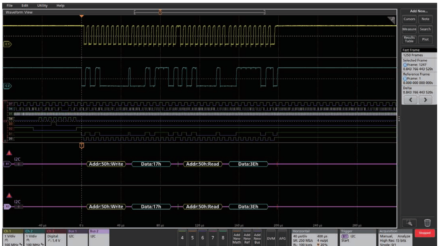
図9. アナログおよびデジタル・シリアルバス信号のFastFrame取得、およびそれぞれのデコードされたバス波形。バス・アクティビティをキャプチャし、パケット間のデッドタイムを無視します。
