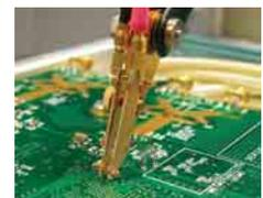
P75PDPM型精密差動プロービング・モジュール先端部
