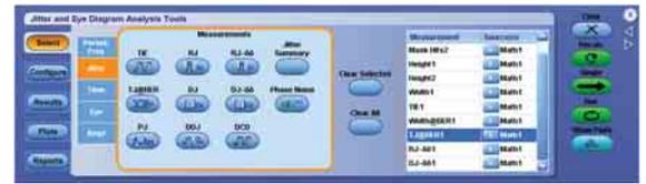
DPOJETの測定選択画面。選択された項目を99項目まで同時に測定
