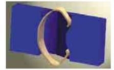
先端コンタクト構造断面
