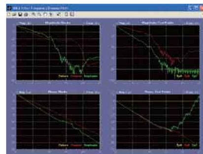
損失がエンベッド/ディエンベッドされたシリアル・データ・リンクの周波数応答特性
