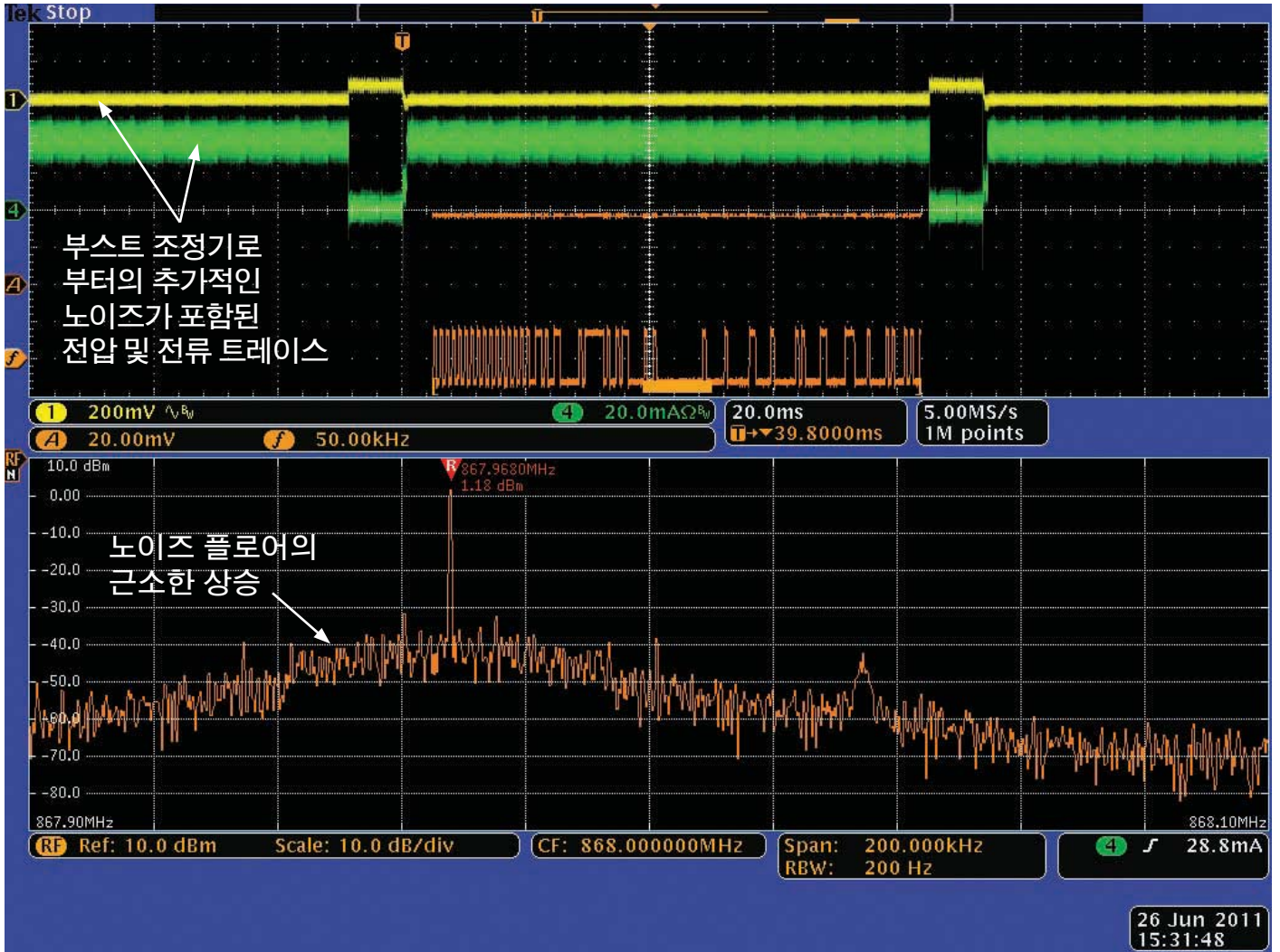
그림 6. 스위칭 전원공급장치를 사용한 스펙트럼 및 전원공급장치 측정
