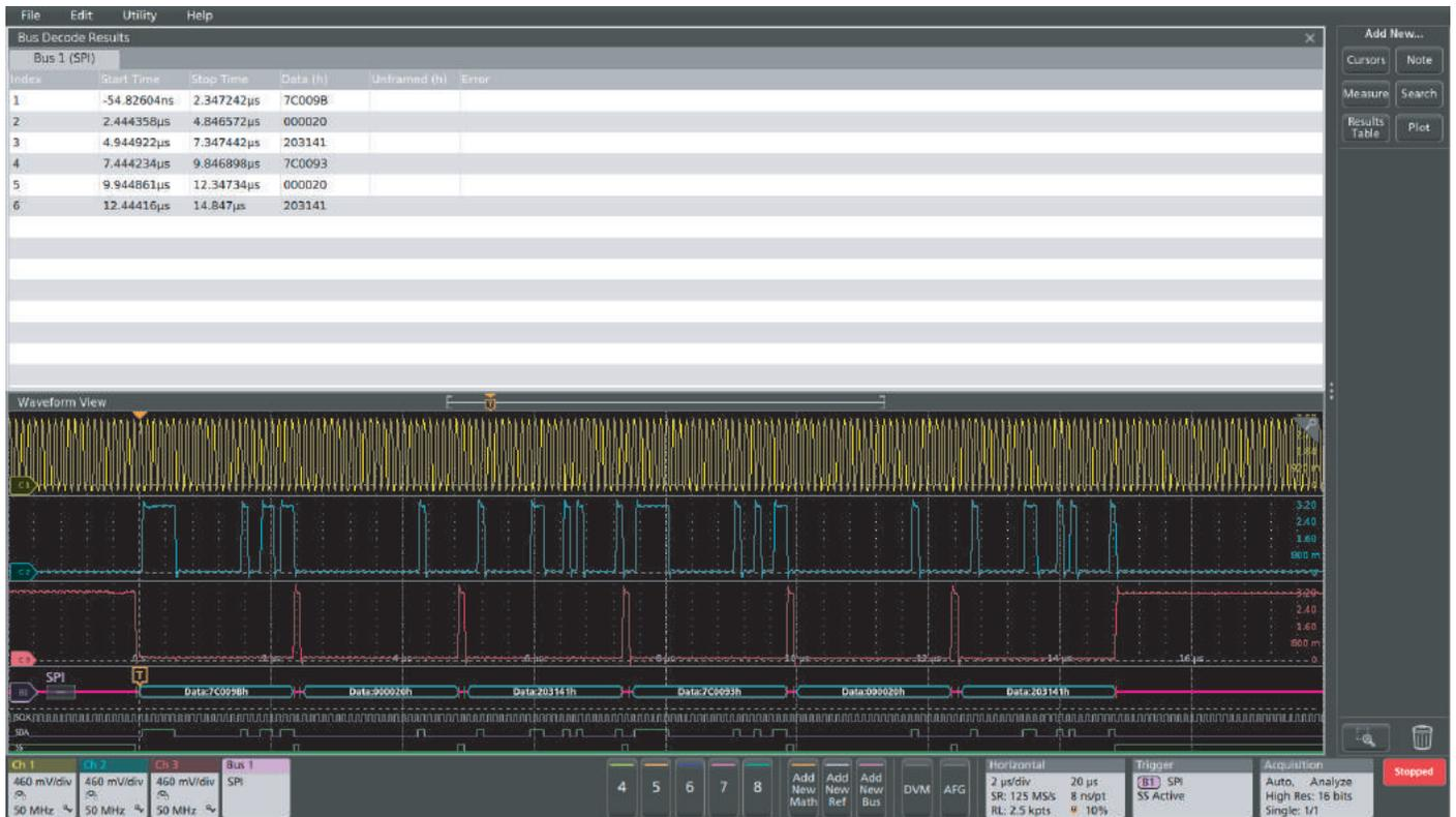
考慮使用菊鏈 SPI 架構的範例系統。子系統控制向系統其餘部分提供射頻時脈的壓控振盪器 (VCO)。VCO 由主 CPU 向 VCO 寫入六個 24 位元字來初始化。訊號似乎符合 SPI 的電氣規格，但是 VCO 並未產生正確的頻率。
