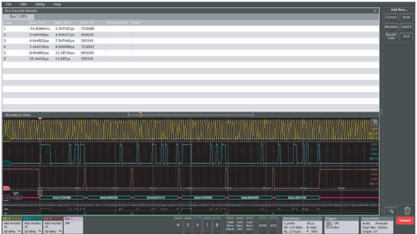
對於韌體工程師而言，結果表格式可能更加實用。這個匯流排活動的時間戳記顯示可以輕鬆地與軟體清單進行比較，並提供執行速度的簡單計算。
