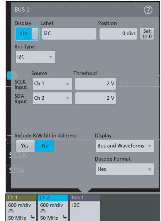
在 Tektronix 示波器上，按下前面板匯流排按鈕，可讓您將示波器的輸入定義為匯流排。只需定義哪個通道時脈和資料開啟，以及用於確定邏輯 1 和 0 的數位閾值級別，即可讓示波器瞭解通過匯流排傳輸的通訊協定。
