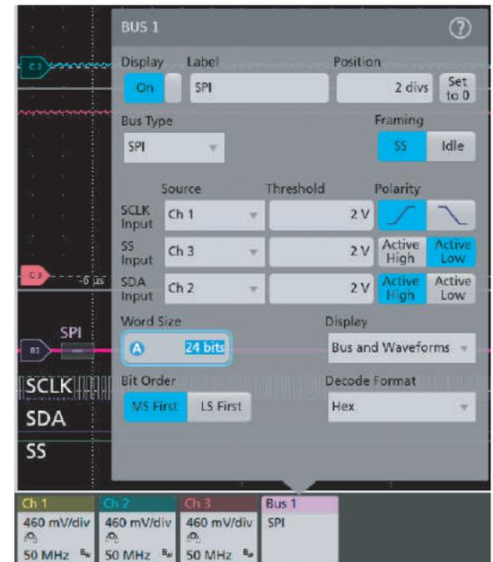
在本例子中，使用被動式探棒在示波器上的類比通道 (通道 1、通道 2 和通道 3) 擷取 SPI 訊號。數位通道也可用於匯流排解碼。使用匯流排組態功能表，您可以指定哪些通道連接到時脈、資料和從屬選擇訊號、閾值、極性和字詞大小，來定義 SPI 匯流排。
