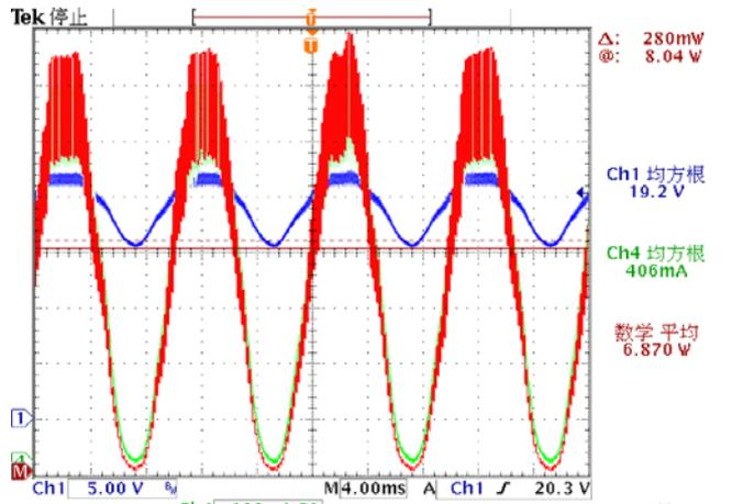
采用示波器瞬时功率积分的方法计算功率，可以有效地避免这些问题，轻松获得准确的功率值。
