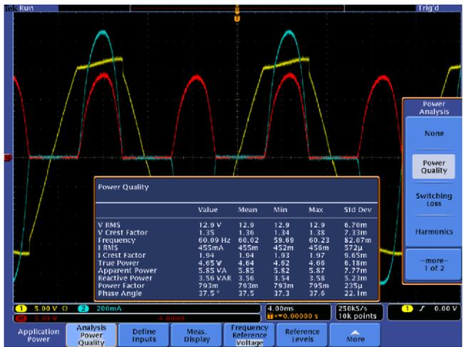
LED 系统效率关键在驱动电源，而驱动电源效率和电源内部的开关损耗直接相关。损失在开关器件中的能量会转化为热量聚集在电源内。降低功率器件的损耗不但是提高电源效率的要求，也是提高系统热稳定性和可靠性的关键因素。功率器件的开关损耗测量不易实现。由于器件在导通和关断工作状态下的电压幅度相差巨大，一般的示波器产品无法在如此大的动态范围下准确测量导通状态下的微小电压，导通损耗无从测量。对于高速切换的功率器件，只能通过电压和电流相乘得到瞬态功率的办法计算功率。这时电压和电流必须是同一时刻的波形，否则误差巨大。但电压探头和电流探头的原理和结构不同，对于高速切换信号的时间延迟也不同。如果不能准确地校正这一偏差，示波器的测量结果是不可信的。泰克的示波器电源测量
