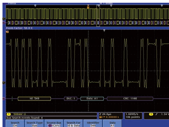
図44. CANバスの取込みから、指定した識別子とデータでサーチした結果の例
