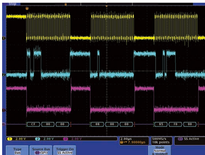
図12. SPIバスにおけるシンセサイザのコンフィグレーション・メッセージ
