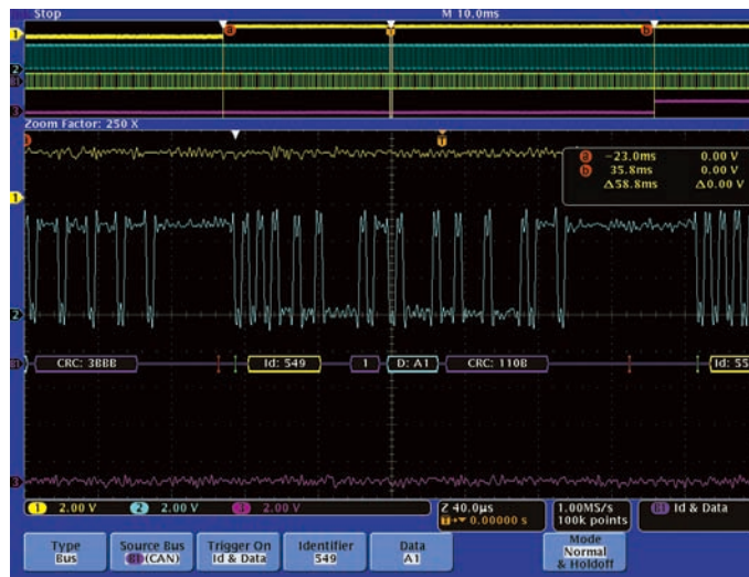
図31. CANバスの識別子とデータでトリガし、取込んだデータのすべてのメッセージをデコードした例
