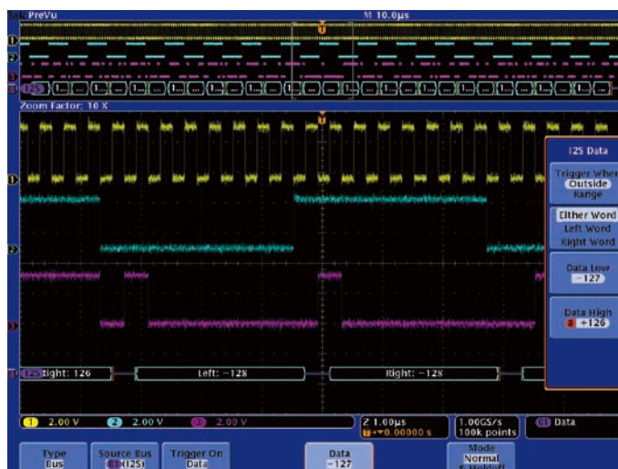
図48. I 2 Sバスにおいて設定範囲外の値にトリガした例
