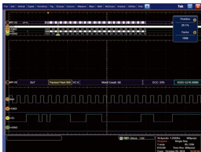
図52. MS070000Cシリーズで表示された、Packed Pixel Stream、24ビットRGB 8-8-8フォーマット・ロング・パケットのデジタル・チャンネル・デコード表示
