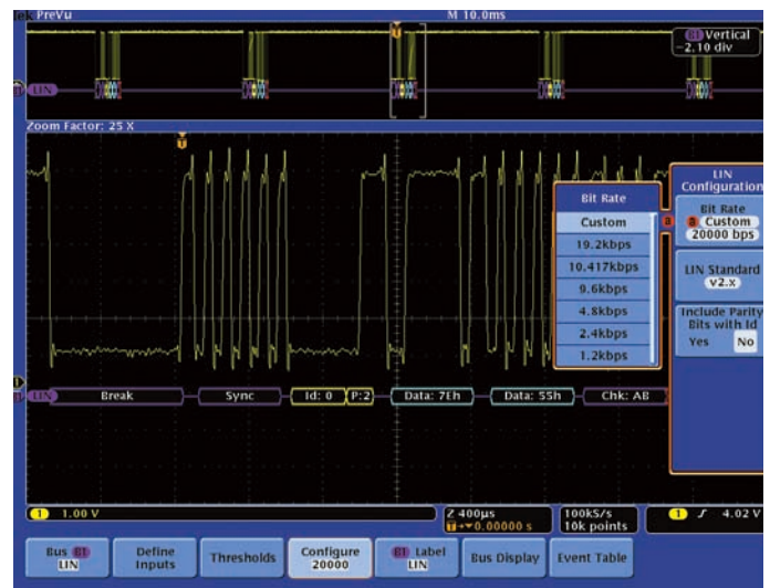
図34. LINバス・サポートの設定メニューとデコードされたフレーム
