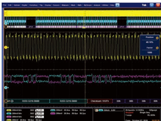
図53. MS070000Cシリーズで表示されたPacked Pixel Streamのアナログ・チャンネル・デコード表示 - チェックサム・エラーが確認できる
