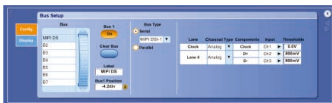
図51. MIPI DSI-1バスの設定例
