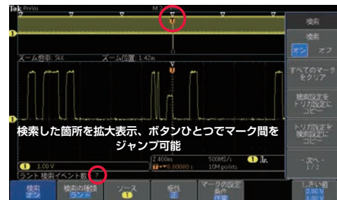
パルス幅の狭い信号を捕捉 (パルス幅トリガ)
