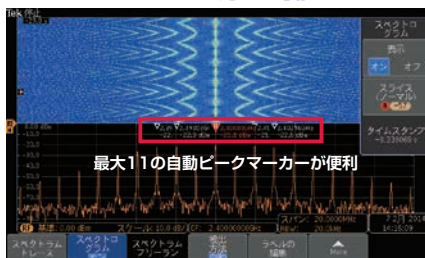
スペクトログラム表示で時間的なRF信号の変異を確認可能
