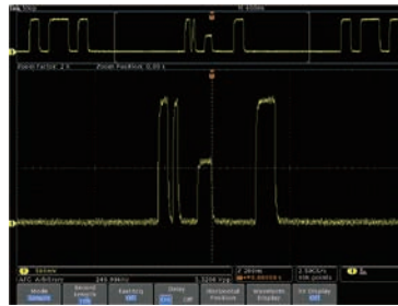
オシロスコープで測定した波形をAFGに取込み
