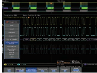
USBフルスピード・バスの特定のデータ・パケットにトリガした例
