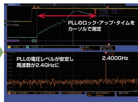
[3] 2.4GHzに到達。所要時間をカーソルで測定
