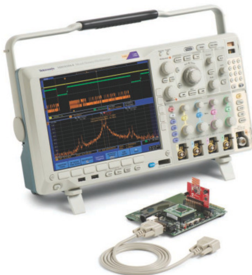
図 1. Tektronix MDO4000 シリーズ・ミックスド・ドメイン・オシロスコープおよび マイクロチップ無線テスト・ボード・モジュール.
