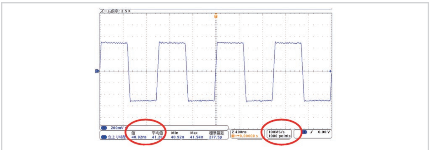
図7 立ち上がり部に4点サンプル点を打てた場合の波形と自動測定結果
