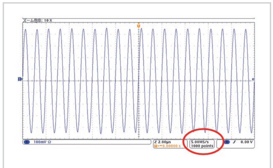
図4 一定振幅の1MHzのサイン波を、サンプル・レート5MS/sでとらえた波形
