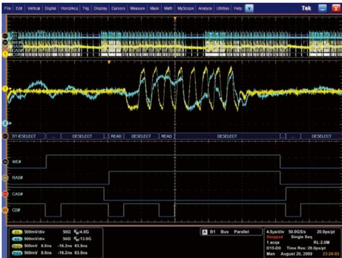
図4. メモリのリード・サイクルによるバス・クオリファイド・トリガの例
