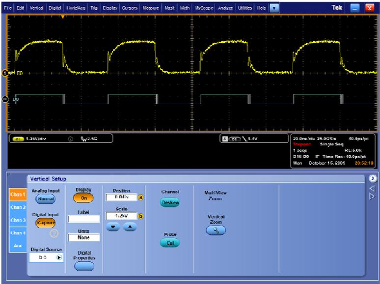
図 6. エッジ部分のリングングにより発生するデジタル・トランジション
