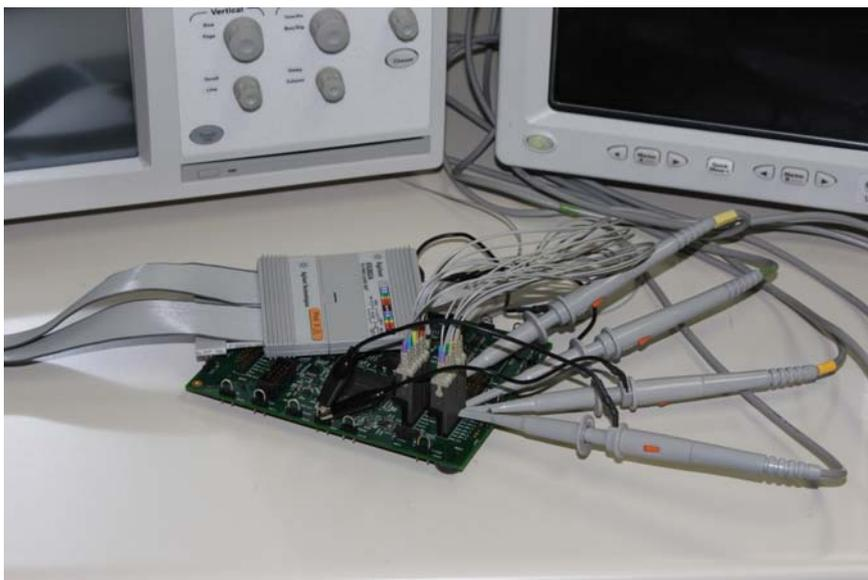
図 3. ダブルプロービングの例
