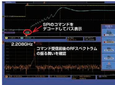
制御用のSPIコマンドに連動するRFスペクトラムの振る舞いを観測している様子。期待通りのスペクトラムが出力されているかを確認可能
