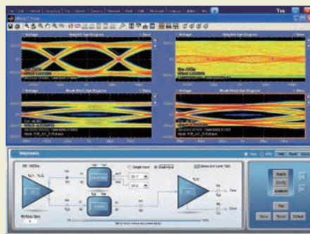
SDLA VisualizerとDPOJETで同時表示した、 PCI Express 3.0の取込信号例
