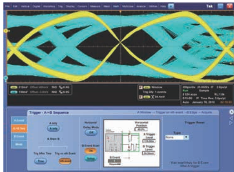
DDR DQSでBイベント・スキャン・トリガし、DQバーストのすべてのビットのアイ・ダイアグラムを作成した例
