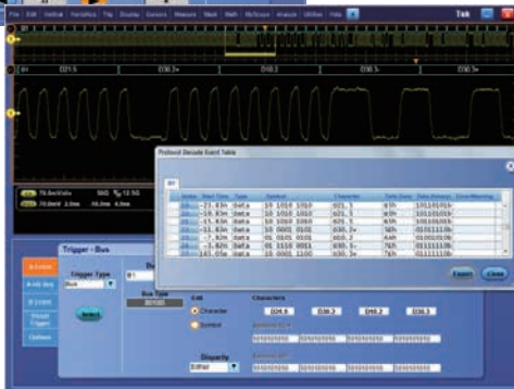
8B/10Bシリアル・パターン・デコード例：デコードされたトラフィックでトリガ、サーチし、アナログ表示との比較によって迅速に問題を解決
