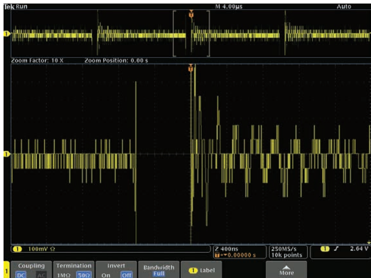
図5. 8ビット分解能のMDO4000Cシリーズによるリングング測定の例
